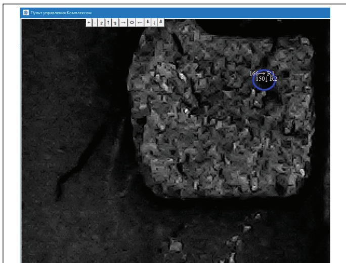
Рис. 7. Измерение дефектов с помощью вписанной окружности (овала)
