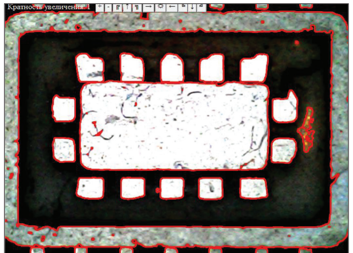
Рис. 11. Пример выявления неопределенного дефекта с помощью установки насыщенности
