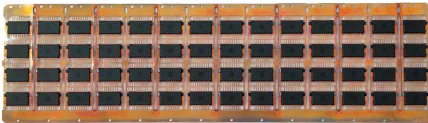
Рис. 1. Матрица с выводными рамками после укладки и разварки кристаллов и герметизации микросхем в пластик
